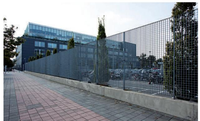
BRITOSTEROPE® ist ein besonders fester Zaun, der aus großen monolithischen modularen Paneelen besteht, die eine hohe Sicherheit und ein angenehmes Aussehen durch Elektroschweißen von vertikalen Flachstäbe und horizontalen Stahldrähte bieten.
